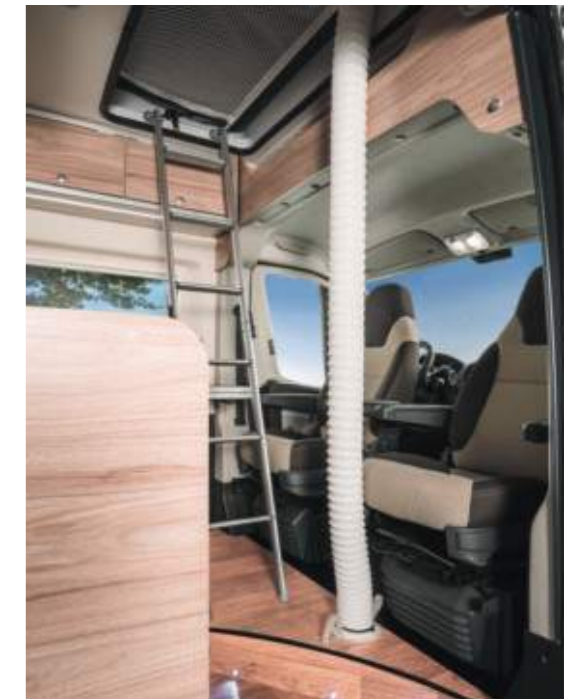
Ein optionaler Warmluftschlauch dient der Beheizung des Bereichs im Aufstelldach beim HYMERCAR.
