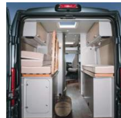
Dank des vertikal aufstellbaren Lattenrosts im Heck des HYMERCAR Free entsteht ein breiter Durchgang, in dem auch große Gegenstände wie z. B. Fahrräder bequem durchgeladen werden können. Die Ladung kann dank der im Laufboden und im Heckbett eingelassenen Zurrösen ideal gesichert werden.
